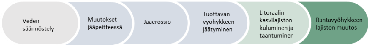
Kuva 10 Vedenpinnan nosto ja lasku sähkön kysynnän mukaan aiheuttaa erityisesti jäiseen aikaan rantojen kulumista ja vaurioittaa rannan eliöstöä.
