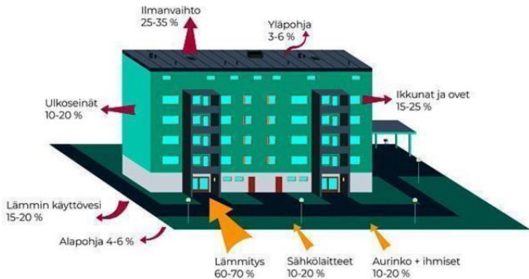
Kuva 15. Asuinkerrostalojen lämpöenergiatase. Vuosina 1960-1980 rakennetut talot 10 .
