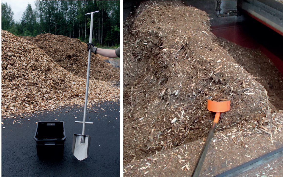
Kuva 2. Kuvassa (vasemmalla) on lapiomallinen näytteenotin polttoainekasasta tapahtuvalle näytteenotolle ja oikealla 3 litran näytteenottokauha liikkuvasta virrasta tapahtuvaan näytteenottoon . Kuva Haklog ky ja Ismo Tiihonen.
