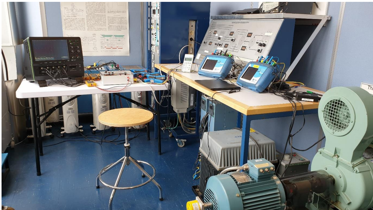
Kuva 7.2. Koejärjestely taajuusmuuttajan jälleenkytkentäkokeissa. Etualalla taajuusmuuttajan syöttämä oikosulkumootori, keskellä takana tutkittava taajuusmuuttaja, vasemmalla mittauksiin käytetty oskilloskooppi ja sen vieressä jälleenkytkentälaitte ja virtapihdit. Oikealla pöydällä taajuusmuuttajan verkkoliittynnän (+ kierrosnopeuden) ja moottorilähdön (+ momentin) mittauksiin käytetyt sähkönlaatuanalysointilaitteet. Oskilloskoopin pöydän takana taajuusmuuttajan verkkoliittynnän rinnalle kytketyt kuormavastukset (3 kpl lämpöpattereita á 610 W) ja epäsymmetrisen jännitekuopan tekemiseen käytetyt kuormavastukset (2 kpl lämpöpattereita, 1 kW ja 2 kW) sekä heikon verkon luomiseen käytetyt kolmivaiheiset tehovastusvaunut.
