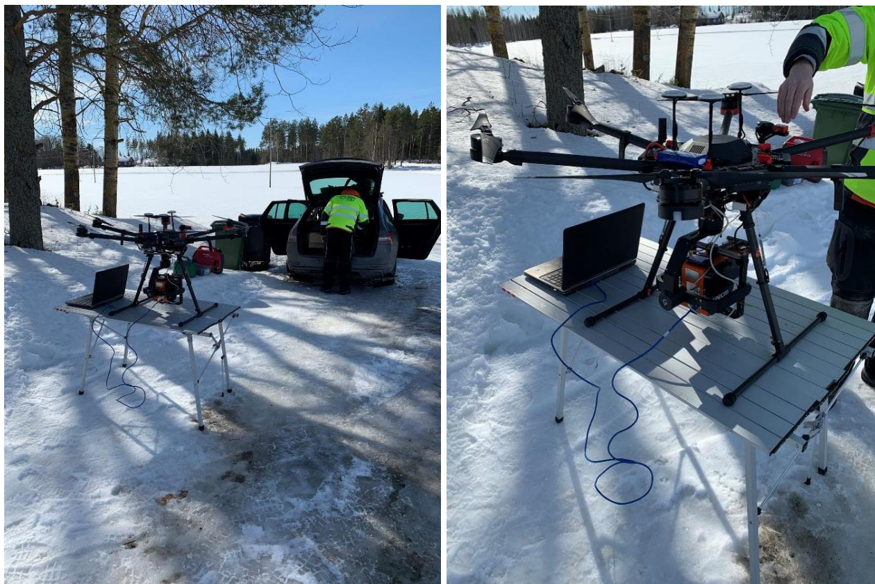
KUVA 10. Toinen maastokäynti maaliskuussa 2021. Kuvassa DJI M600 dronea ja siihen kiinnitetty AFX17 hyperspektrikameraa valmistellaan kuvauslentoa varten.
