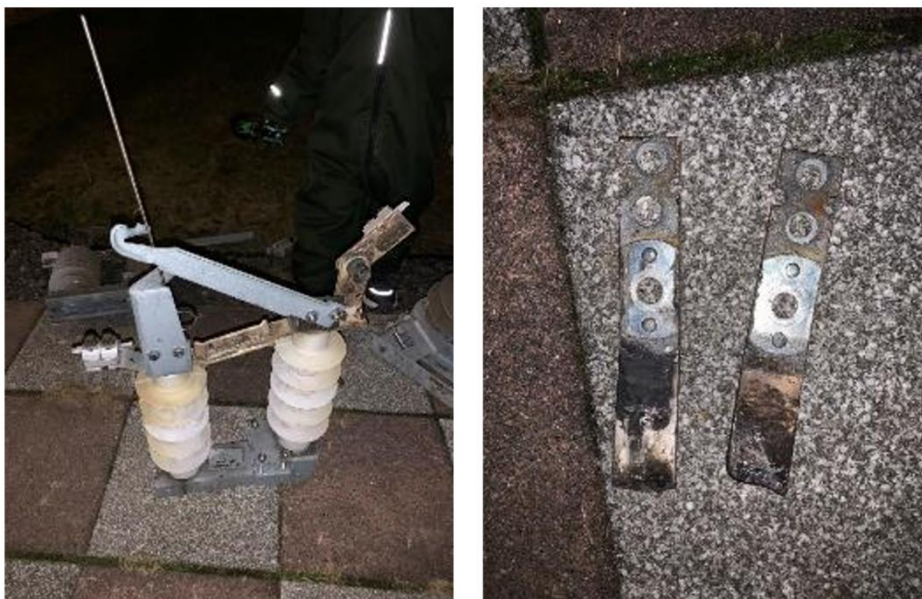
KUVA 22. NPS-tyyppin erotin ja palaneet koskettimet.
