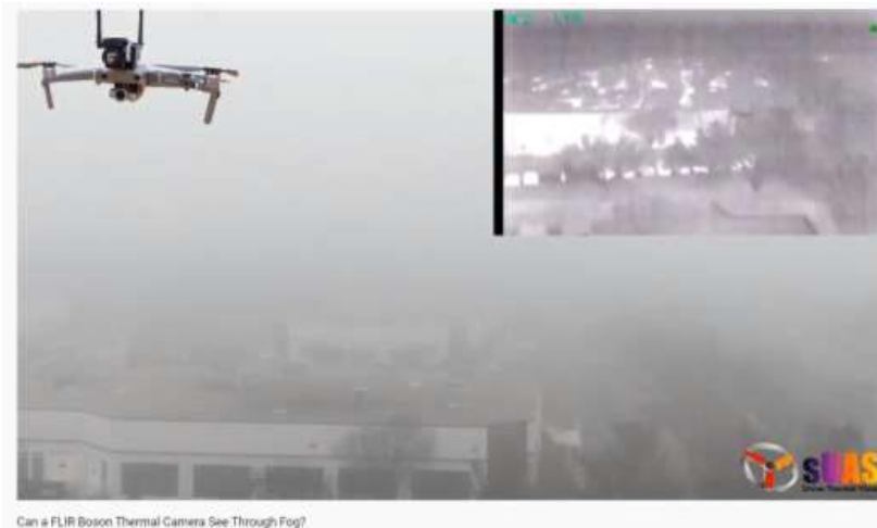
KUVA 4. Drone-lämpökamera näkee sumussa paremmin kuin RGB kamera, mutta heikentyneesti kuitenkin. (sUAS.com 2018)
