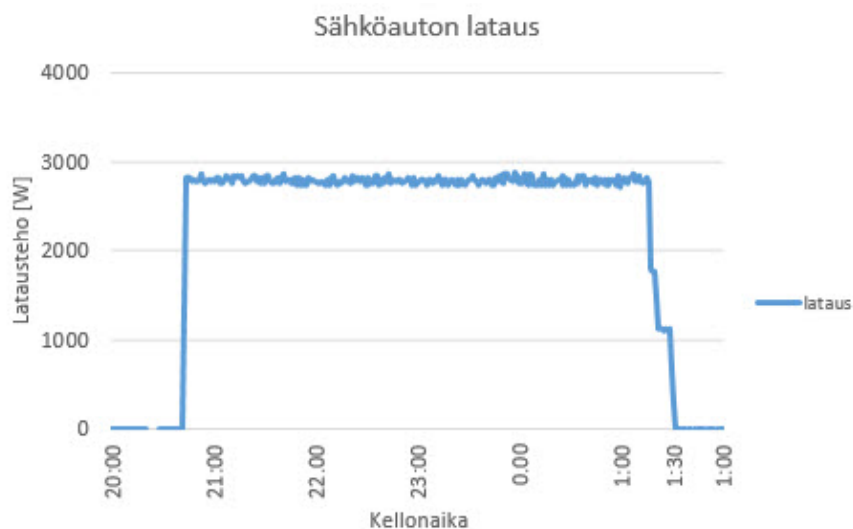
Kuva L1.7 Sähköauton 1-vaiheinen kotilataus.
