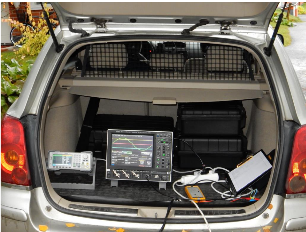
Kuva 7.34. HFCT-mittauslaitteisto henkilöauton tavaratilassa (oskilloskooppi, differentiaalimittapää 50 Hz vaihejännitteen mittaamista varten (pj-rasiasta) ja signaaligeneraattori kaapelin pulssituksesta varten).
