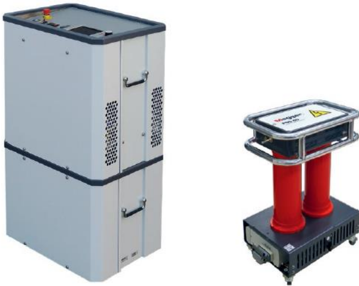
Kuva 3.2. Tutkimushankkeessa käytetty Megger Sinus 45 VLF-häviökerroinmittauslaitteisto (tornin ylempi osa vasemmalla) ja siihen yhdistetty DAC-osittaispurkausmittauslaitteisto (tornin alempi osa vasemmalla ja kytkentäkondensaattori oikealla).
