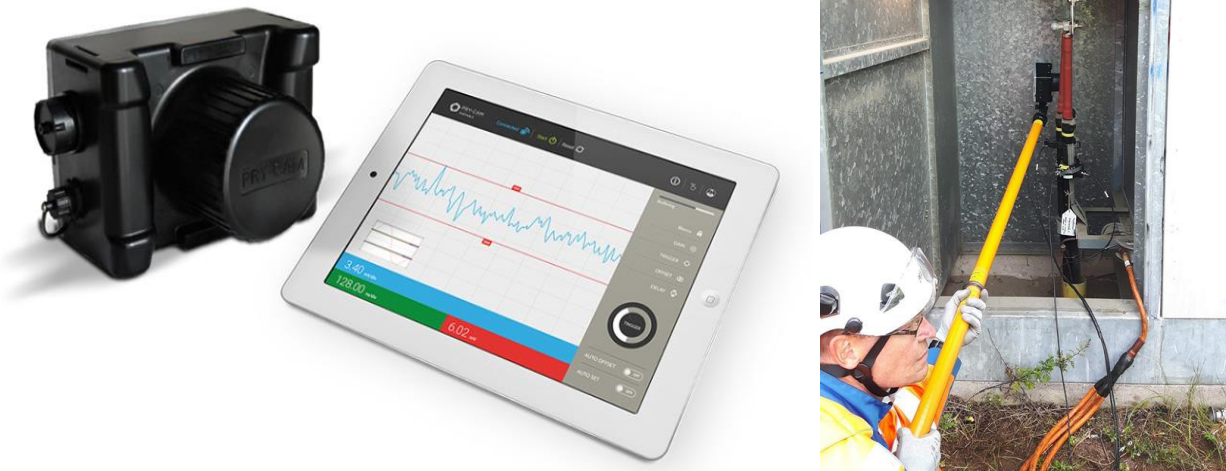
Kuva 3.11. Pry-Cam-laitteisto ja esimerkkikuva käyttötilanteesta.
