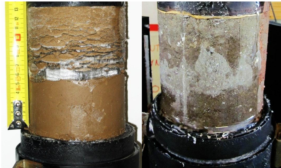
Kuva 3.5 Koekappaleita routanousukokeen jälkeen. Vasemmalla on voimakkaasti routinut, jäälinssejä muodostanut koekappale, ja oikealla routimaton koekappale. (Kuvat: Tero Jokinen, Ramboll)
