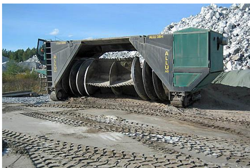
Kuva 12.7 Lentotuhkien jalostamiseen soveltuva aumasekoitin. (Kuva: Harri Jyrävä, Ramboll)
