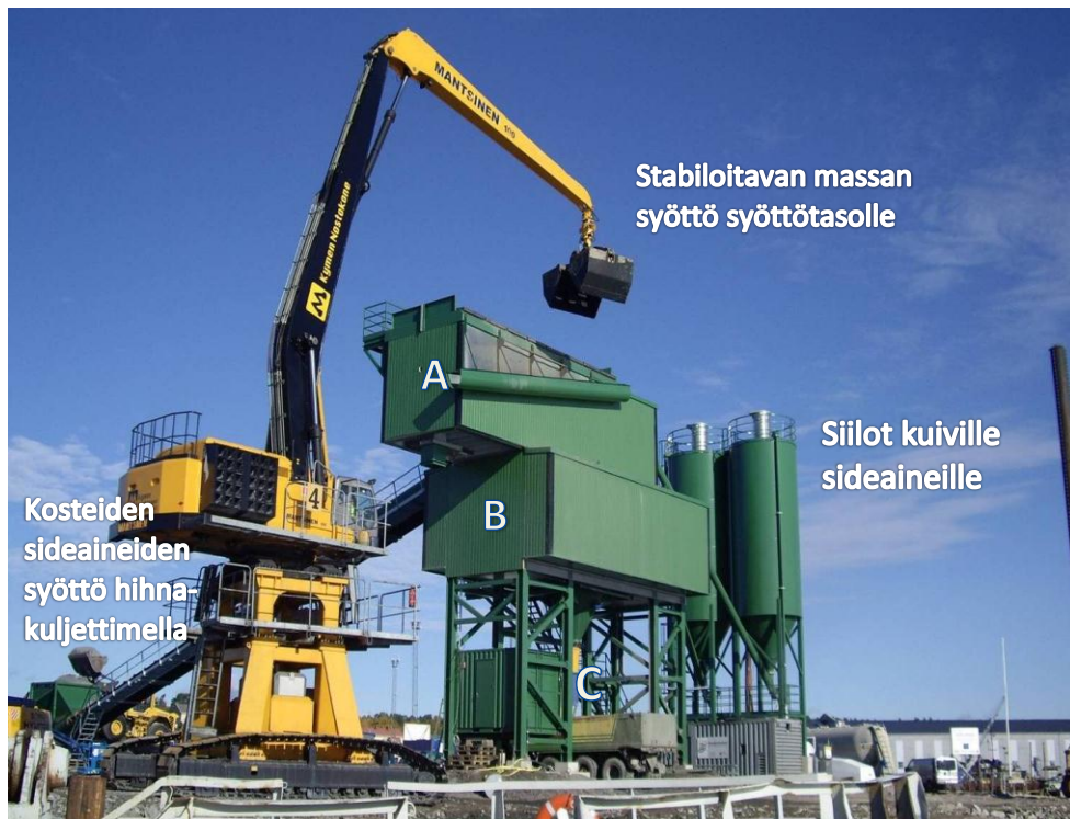
Kuva 8.2. Prosessistabilointilaitteiston toimintaperiaate. Stabiloitava massa syötetään proomuista aseman syöttötasolle A, jossa tapahtuu esisekoitus ja homogenisointi. Syöttötasolla annostellaan myös reseptin mukaiset sideainekomponentit jotka tulevat joko takana olevista silloista tai kuvan vasemmassa reunassa näkyvältä hihnakuljettimelta. Ruoppausmassa ja sideaineet sekoitetaan paineistetussa kaksoisakselisekoittimessa B. Käsitelty massa puretaan osassa C ja siirretään loppusijoitusalueelle. (Kuva: Biomaa Oy)
