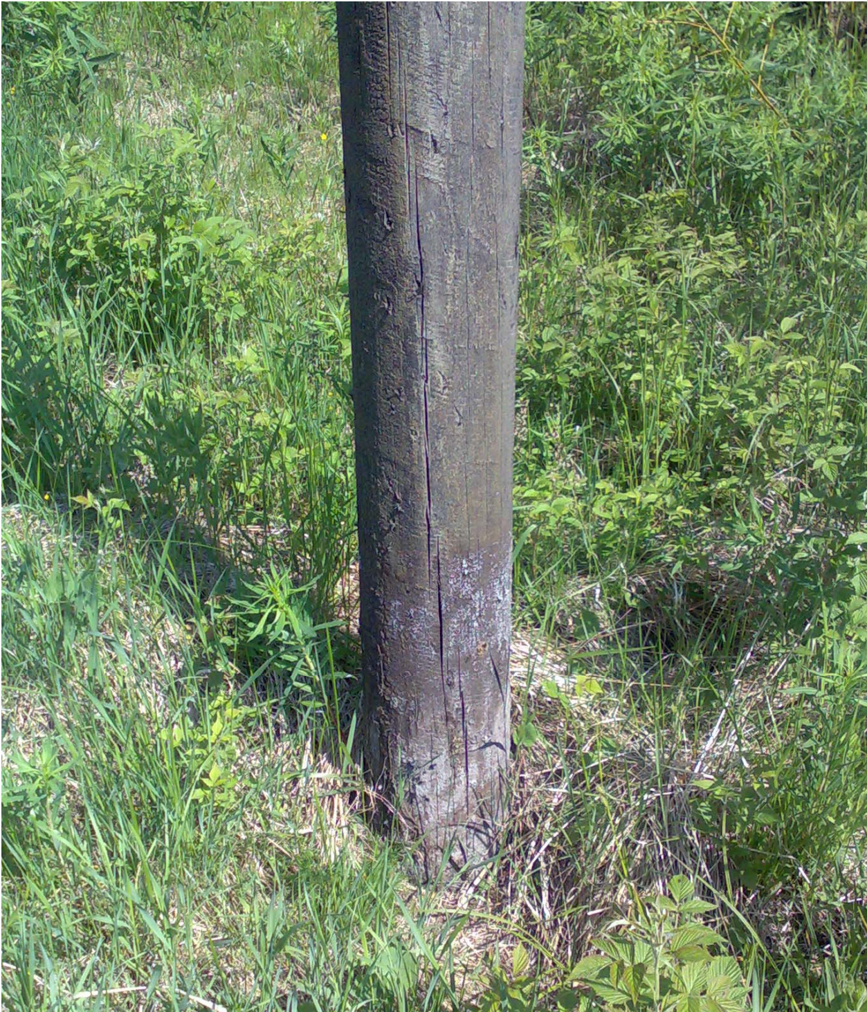
Kuva 23. Kahdeksan vuotta vanhan mäntyöljykylästetyn puupylvään tyviosa, jossa öljypitoisuus noin 100 kg/m 3 .
