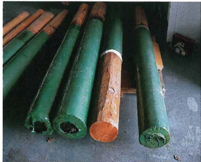
Figur 7. Försöksstolpar försedda med Blotrans mekanisk skydd av stolproten. Ur Love et al 2007.
