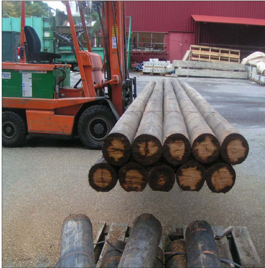
Kuva 28. Furfuraalialkoholilla käsitellyissä pylväissä esiintyy paljon vakavia sydänhalkeamia. Kuvassa ne näkyvät hyvin, koska halkeamien kautta myös sydänpuu on päässyt kyllästymään.
