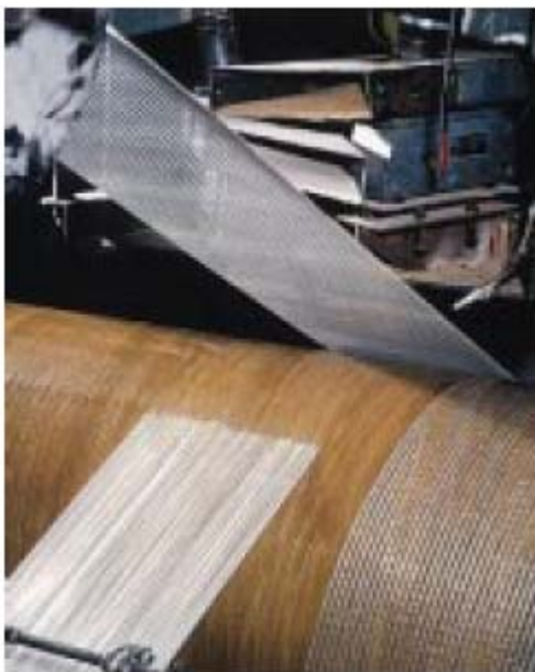
Kuva 47. Komposiittipylvään valmistus kelaustekniikalla (vasen) ja komposiittipylvään käsittelyä maastossa (oikea).
