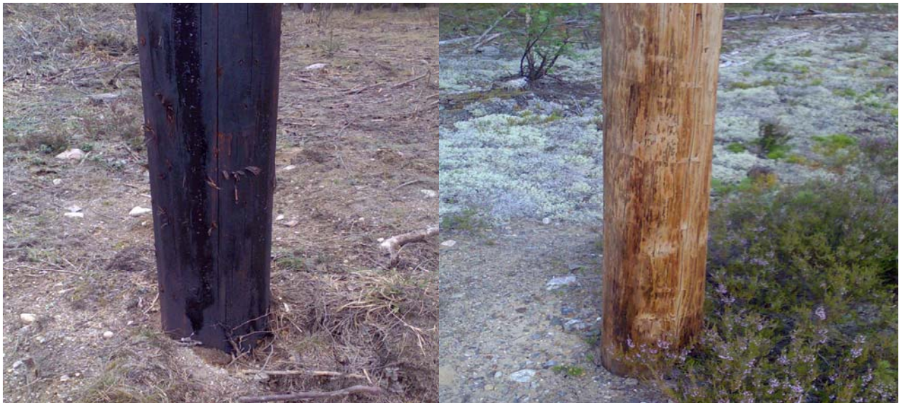
Kuva 12. Vasemmalla NTR A-luokan ( 110 \text{ kg/m}^3 ) kreosoottipylväs, josta nähdään kreosoottipylväiden pääongelma – kreosootin tihkuminen pylvään pintaan. Oikealla 9 vuotta vanha kreosoottipylväs, jossa kreosoottipitoisuus on vain 80 \text{ kg/m}^3 – lahoamisen merkkejä ei kuitenkaan ole havaittavissa.
