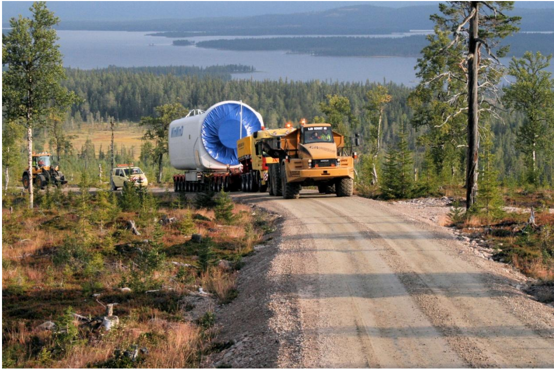
Kuva 25. Tuulivoimalan osien kuljetus tietä pitkin vaatii usein erikoiskuljetuksen. Painavat ja suurikokoiset osat asettavat vaatimuksia tieverkolle. Kuvalähde WinWind (2012)
