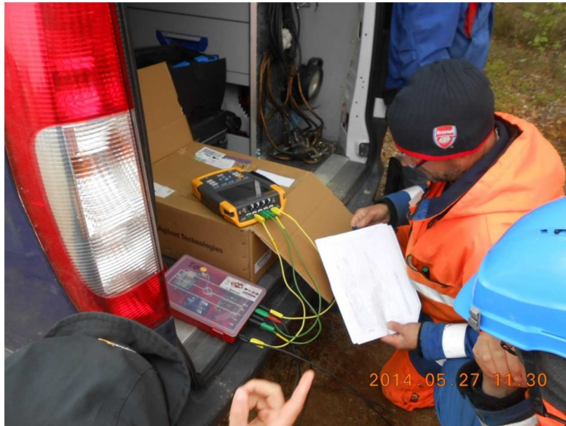
Kuva 12. Esimerkki mittauksesta muuntamon päässä. Mittaaja on juuri kirjaamassa mittarien kanavanumeroita mittauspöytäkirjaan. Kuvassa näkyvät hyvin myös kaksi rinnakkaista mittalaitetta.
