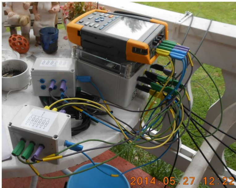
Kuva 10. 1 \text{ k}\Omega vastukset (edessä vasemmalla) kytkettynä asiakkaan pään mittauskanavien rinnalle kuormitetussa kosketusjännitemittauksessa.
