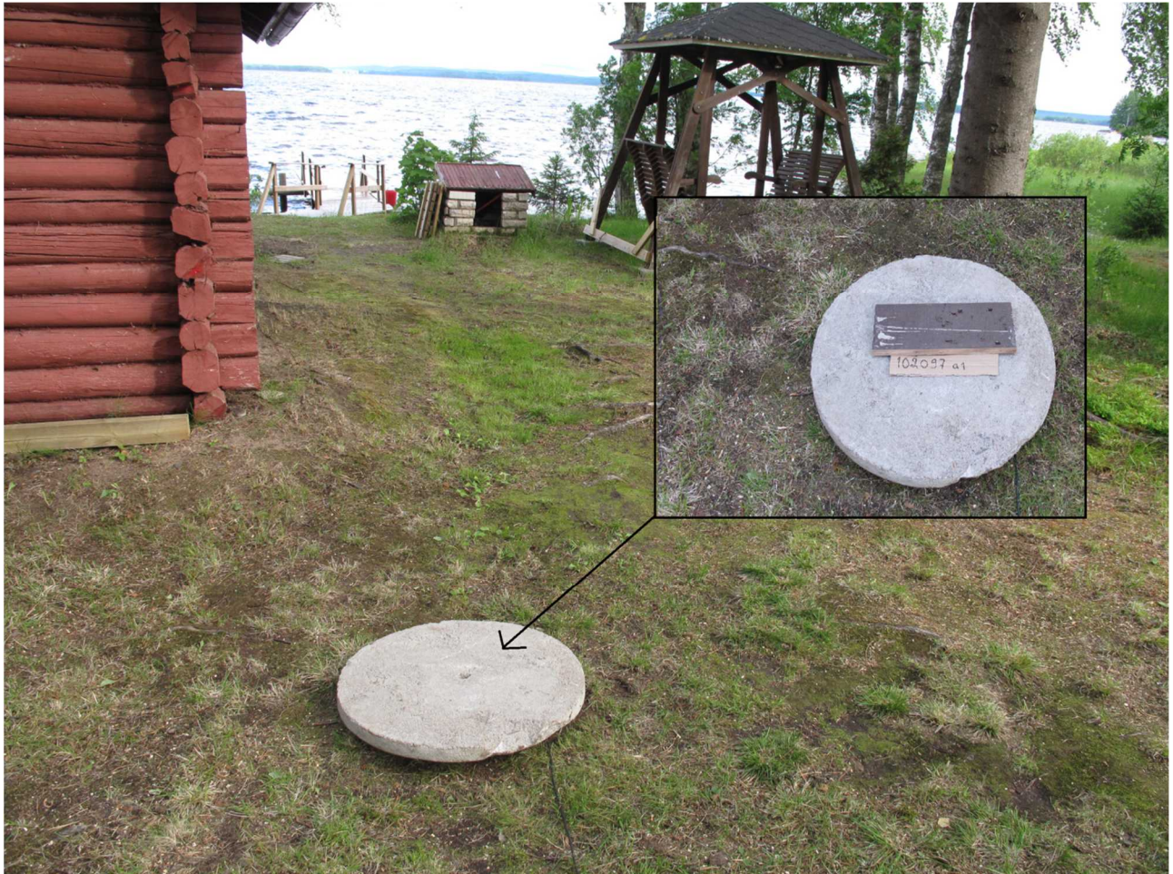
Kuva 18. Hannusranta / a1 (Lat 64.328005, Lon 27.771747); R_{\text{kontakti}} = 4.6 \text{ k}\Omega (kuiva) ja 1.2 \text{ k}\Omega (märkä); siirtyvä jännite tyhjäkäyväänä 0.84 p.u.
