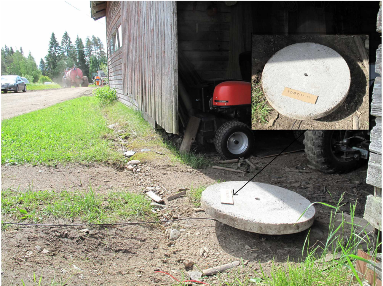
Kuva 17. Sotkamo / a1 (Lat 64.27512057, Lon 28.66285188); R_{\text{kontakti}} = 2.7 \text{ k}\Omega (kuiva) ja 1.9 \text{ k}\Omega (märkä); siirtyvä jännite tyhjäkäyvänä 0.1654 \text{ p.u.}
