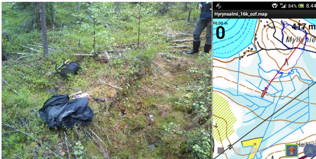
Kuva 9. Esimerkki muuntamopään maastoon viedystä mittaaselektrodista. Piikkielektrodi (kuvassa ojan pohjalla) pyritään viemään mahdollisimman sivuun kaikista kyseisen muuntopiirin yhdistettyyn maadoitusjärjestelmään liittyvistä yksittäisistä maadoituksista. Tämän mittaaselektrodin etäisyys muuntamon maadoitukseen oli noin 420 metriä.
