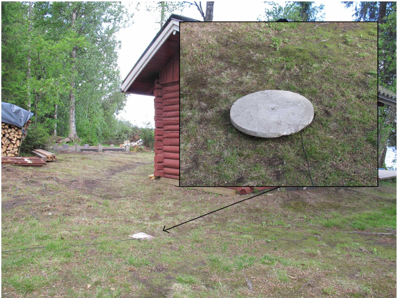
Kuva 8. 400 cm 2 kuparilevyelektrodi ja 50 kg paino, sekä mittajohto (puhelinparikaapelia, mallia Försvarsmakten)
