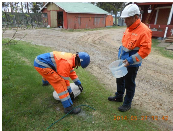
Kuva 11. Levyelektrodin kasteleminen vedellä ennen uusintamittausta.
