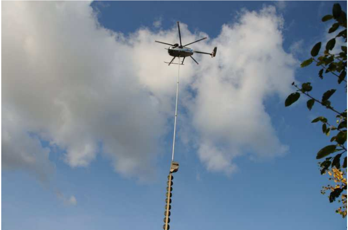
Kuva 5. Helikopteri varustuksena oksasaha, Heliwest Oy
