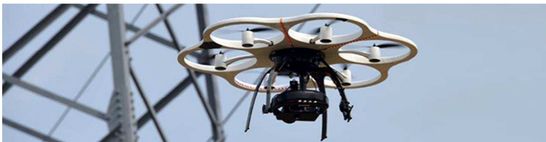
Kuva 1 - Itävaltalainen sähkökäyttöinen Aibotix-robottihelikopteri verkoston tarkastustehtävissä
