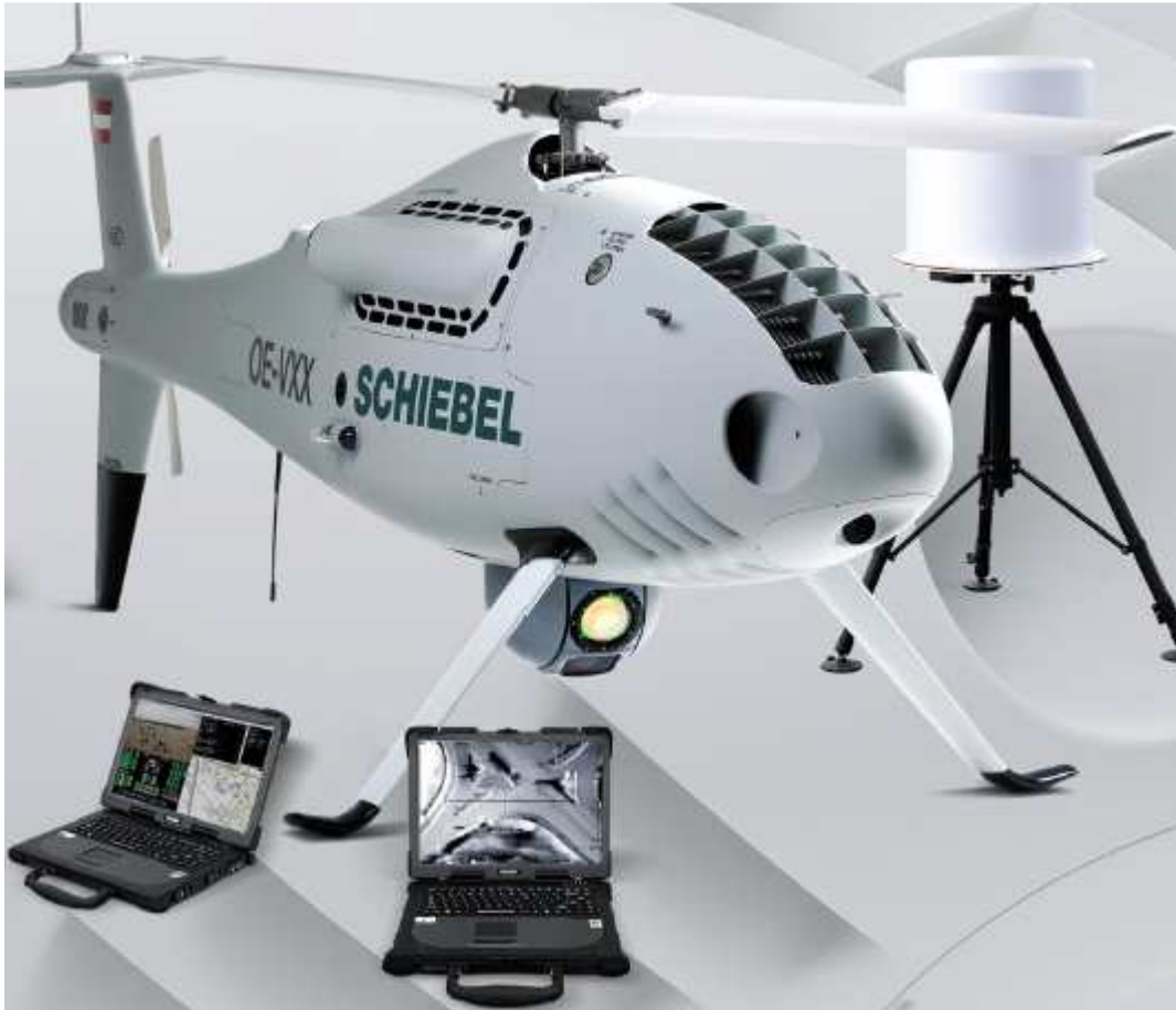
Kuva 17. Itävaltalaisen Schiebelin näkemys kahdennetusta kauko-ohjausasemasta, viestintälinkistä sekä B-VLOS-lentoihin kykenevästä polttomoottorikäyttöisestä lentorobotista
