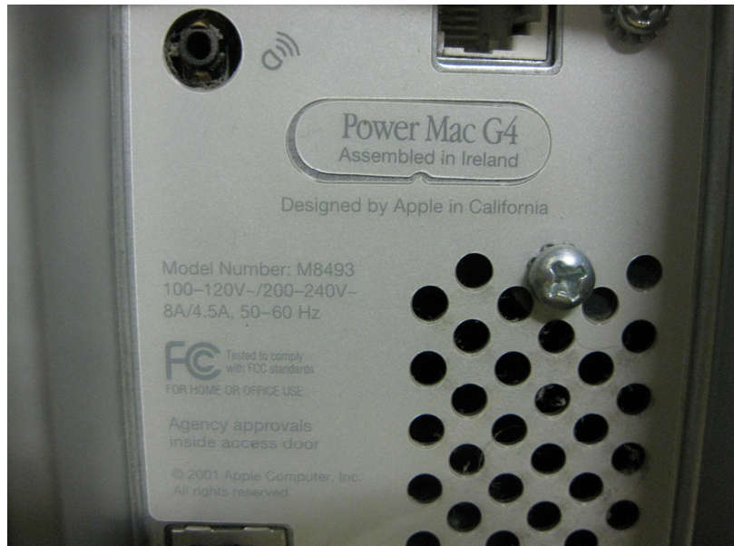
Kuva 6.13. Pöytätietokone, jonka tehonlähte häiritsi PLC-luenta.
