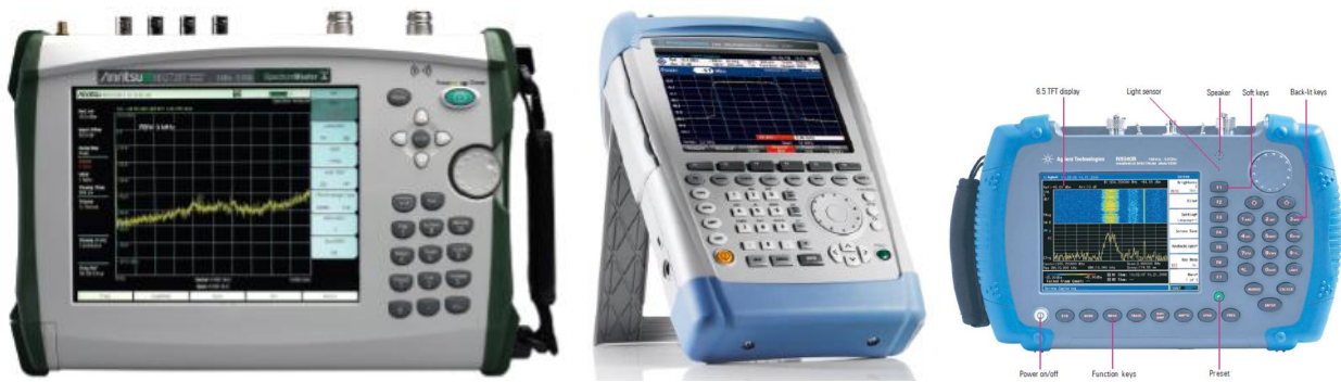
Kuva 9.3. Esimerkkejä kädessä pidettävistä spektrianalysaattoreista (Anritsu MS-2720T, Rohde & Schwarz FSH-4, Agilent N9340B).
