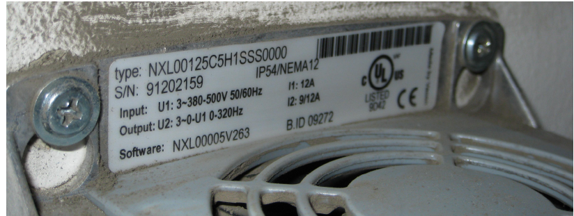
Kuva 6.19. a) Häiriöitä aiheuttaneet Vacon NXL taajuusmuuttajat b) taajuusmuuttajan tyypikilpi.
