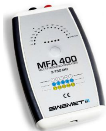
Kuva 9.5. Esimerkki PLC/häiriöanalysaattorista (Swemet MFA 400).
