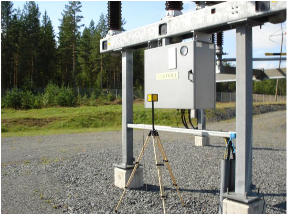
Kuva 5.3 Esimerkki sähkökenttämittauksesta työpisteestä ” katkaisijan paikallisohtaus maantasolta” 110 kV sähköasemalla (sähkökenttä 0,8 kV/m, mittauskorkeus 1,7 m).
