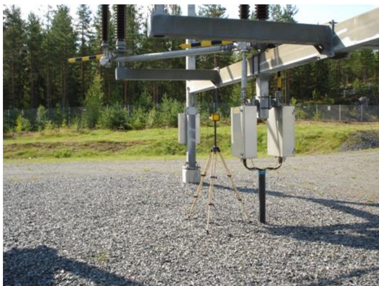
Kuva 5.5 Esimerkki sähkökenttämittauksesta työpisteestä ”erottimen paikallisohjaus maan tasolta” 110 kV sähköasemalla (sähkökenttä 1,9 kV/m, mittauskorkeus 1,7 m).
