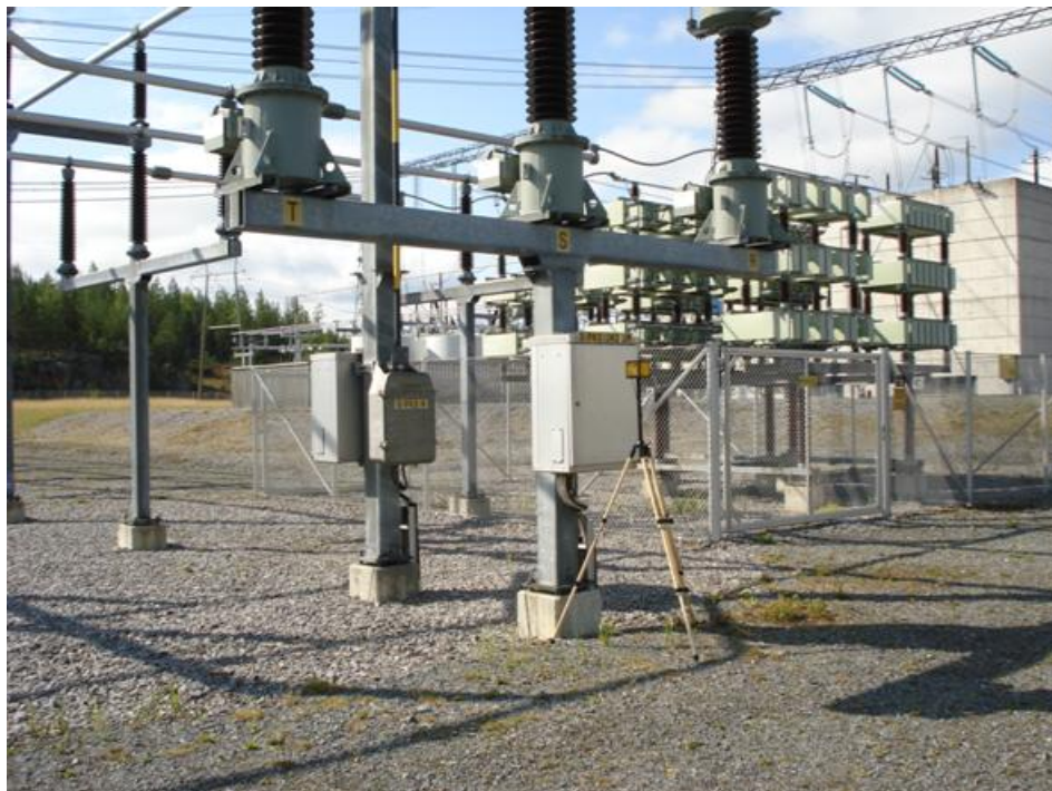
Kuva 5.6 Esimerkki sähkökenttämittauksesta työpisteestä ”ulkokytkinlaitoksen jakokaapin tarkastus maan tasolla” 110 kV sähköasemalla (sähkökenttä 0,9 kV/m, mittauskorkeus 1,7 m).
