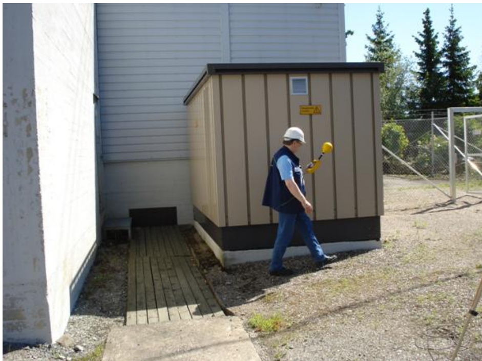
Kuva 5.26 Esimerkki mittauksesta työpisteestä ”kävely kondensaattorien lähellä tai ovella toimiminen” 110 kV sähköasemalla (magneettikenttä 2,5 \mu T).
