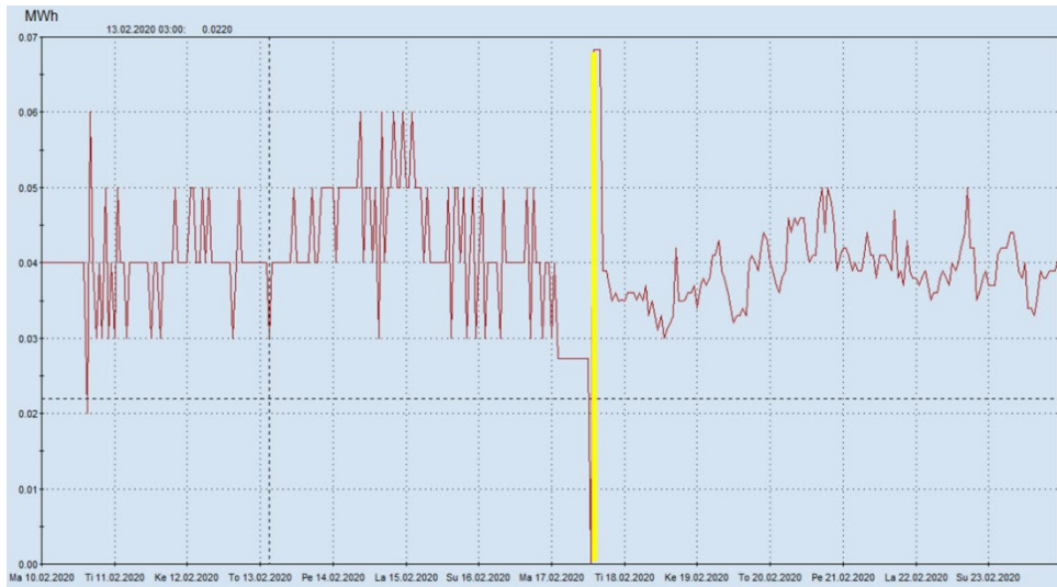
Kuva 6. Esimerkki mittarin määräaikaisvaihdon yhteydessä tehtävästä tietojen oikeellisuuden validoinnista. Mittarin vaihto on merkitty kuvaan keltaisella viivalla, jolloin kulutus on nollassa. Sen jälkeinen piikki kuvaa noin kahden tunnin kulutusta mittarin vaihdon jälkeen. Etäluentayhteys on saatu toimimaan siten, että ensimmäisen tunnin lukematieto ei vielä ole siirtynyt järjestelmään.
